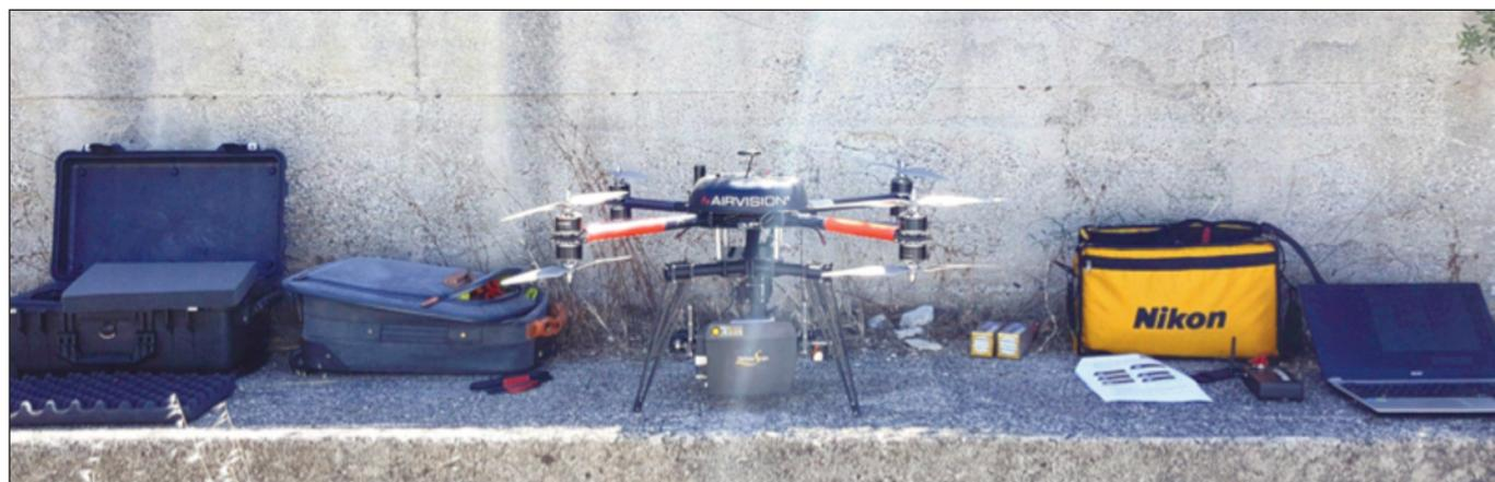
Figura 3 - APR modello NT8-C Airvision con LiDAR Yellow Scan (peso: 2,2 Kg).
