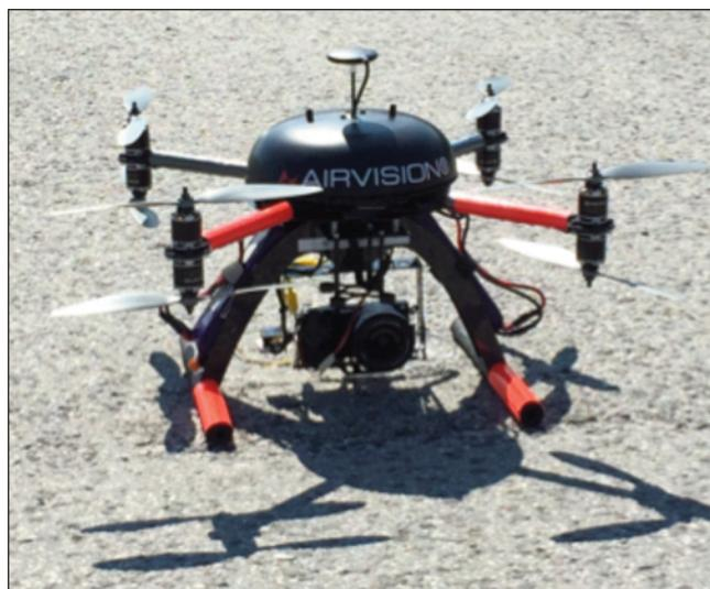
**Figura 8** - APR modello NT4-C Airvision con installata fotocamera Canon EOS-M da 18 Mpixel.
